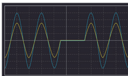
电压瞬断拉载功能
